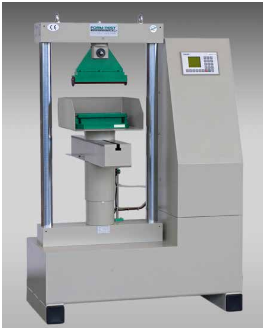
Bild zeigt Prüfmaschine mit Zubehör „Spaltzugprüfeinsatz“
