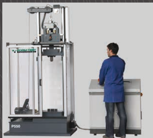
Impaktversuch mittels Fallgewichtsprüfung
